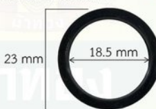
HG767-92 Grease Seals ซีลกันจาระบี หนา 2.5mm
