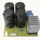
■ HG-V-316 Circuits MMA-200 แผงวงจร MMA-200
